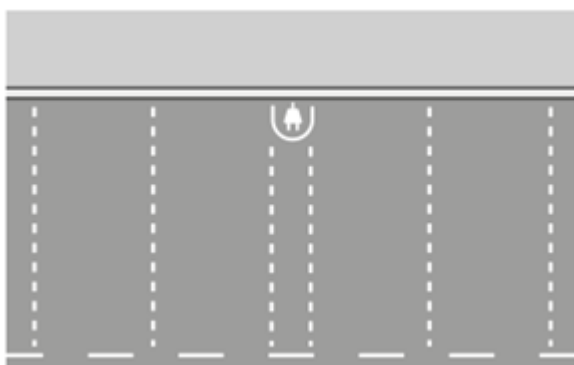
Figuur 25 Plaatsing laadpunt in parkeervak 'Laadkabels en laadpalen, hoe houd je het trottoir veilig en toegankelijk? (CROW, 2025b).
