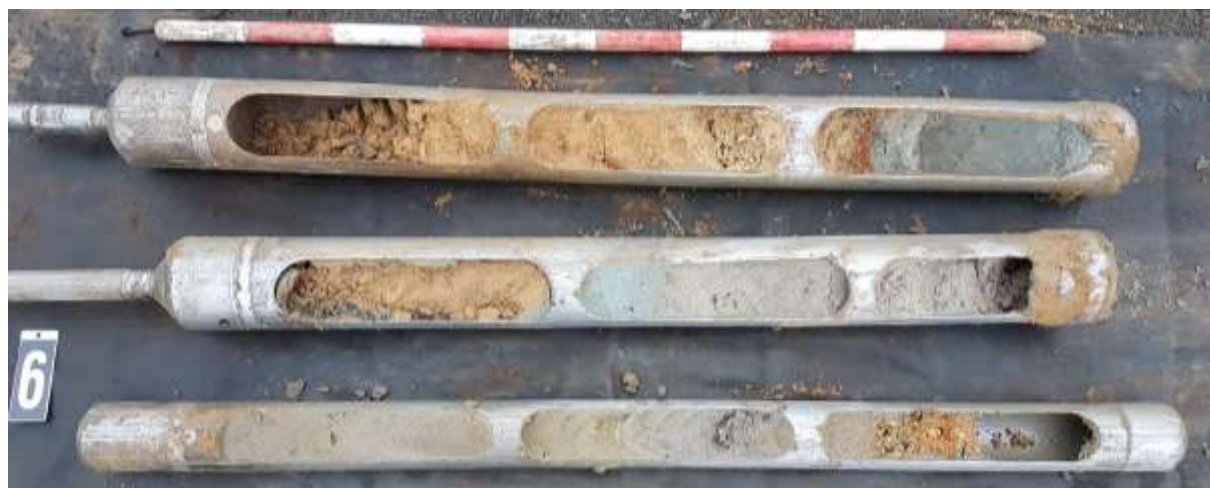
Figuur 11: Boring 6, uitgelegd per meter van links boven naar rechts onder.
