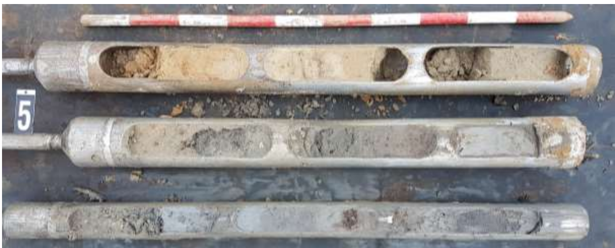
Figuur 10: Boring 5, uitgelegd per meter van links boven naar rechts onder.
