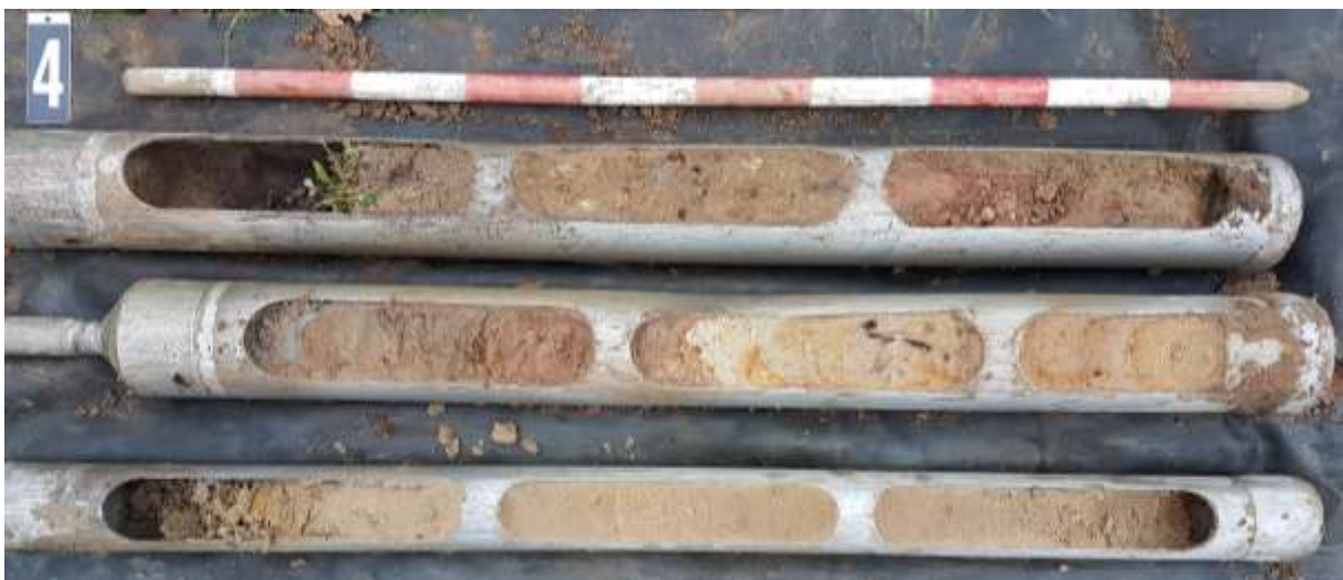
Figuur 9: Boring 4, uitgelegd per meter van links boven naar rechts onder.
