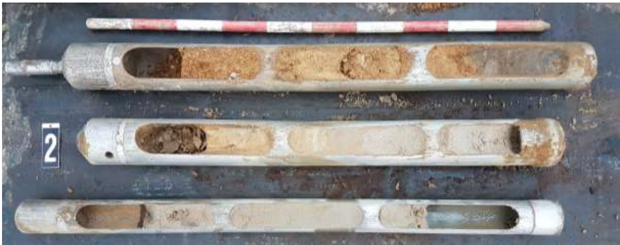
Figuur 7: Boring 2, uitgelegd per meter van links boven naar rechts onder.
