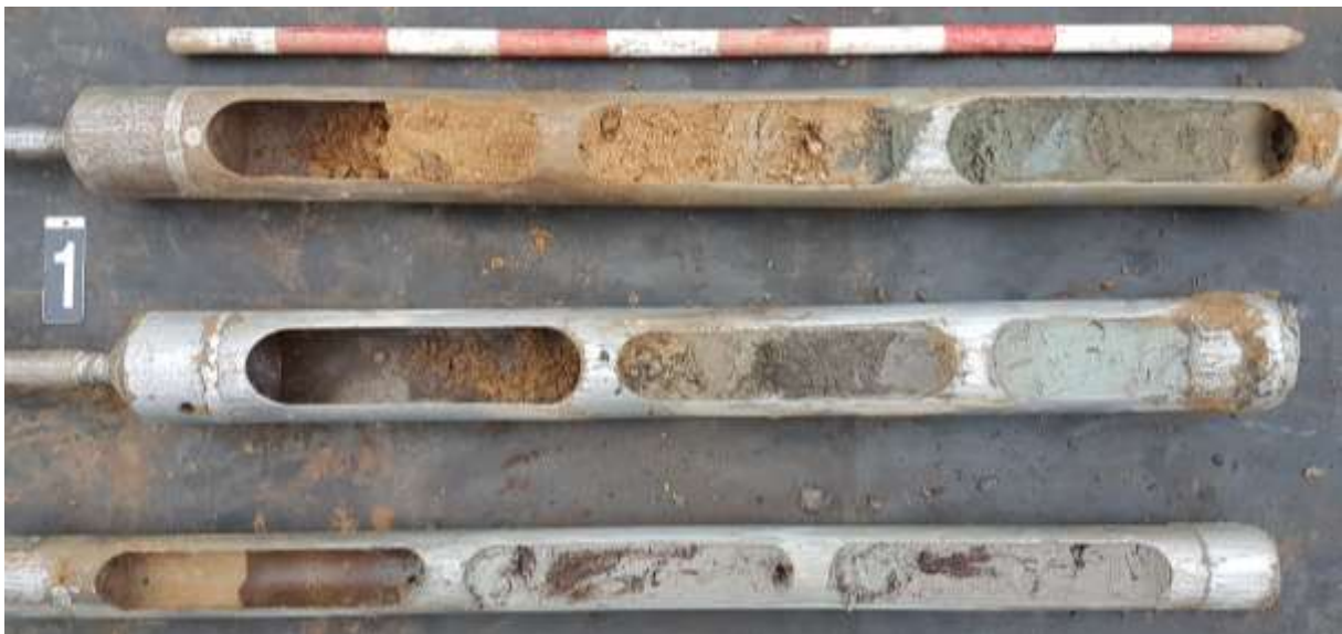
Figuur 6: Boring 1, uitgelegd per meter van links boven naar rechts onder.
