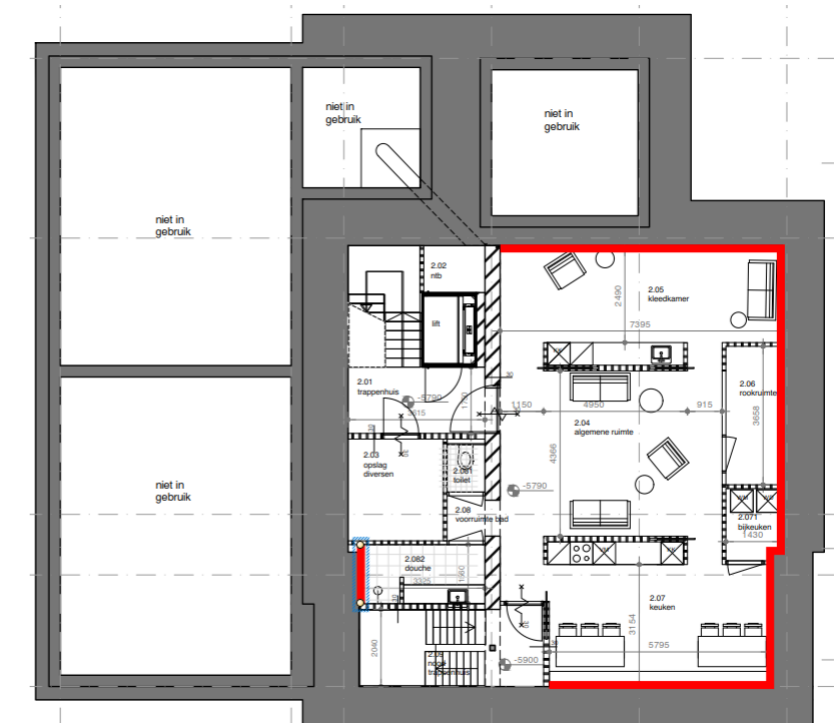
Figuur 8: voorzetwand verblijfsruimten verdieping -2
