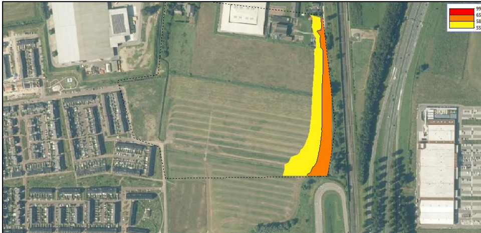
Figuur 11; spoorweglawaai op 8 m boven maaiveld
